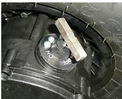
Abb.1.Ausschalten der Rekuperation- der Elektroenergiegewinnung
