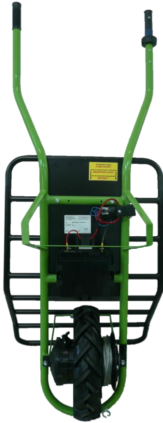
Version Schweizer Karre mit Seilwinde
