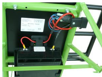
Abb.8- Stellenbezeichnung der Abschaltung des Akkus von der Leitung
